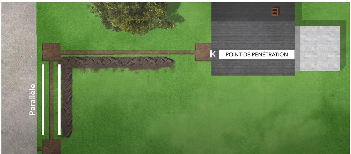
Un puits de 1 m x 1 m avec une profondeur de 1,2m doit être réalisé à l'endroit où le branchement va entrer dans le bâtiment pour permettre la manipulation des câbles ou des conduites par nos techniciens. Il servira également à interrompre les gaines venant de l'extérieur afin d'éviter toute pénétration d'humidité ou de gaz dans le bâtiment.
